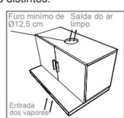
Usando o produto como depurador, deverá ser trocado o filtro de carvão ativado a cada três a seis meses, de acordo com o seu hábito de uso. A aquisição do filtro de carvão ativado poderá ser feita em uma assistência técnica credenciada ou através do nosso site: [www.fogatti.com.br](http://www.fogatti.com.br) ou via **QRcode** no fim do manual.
