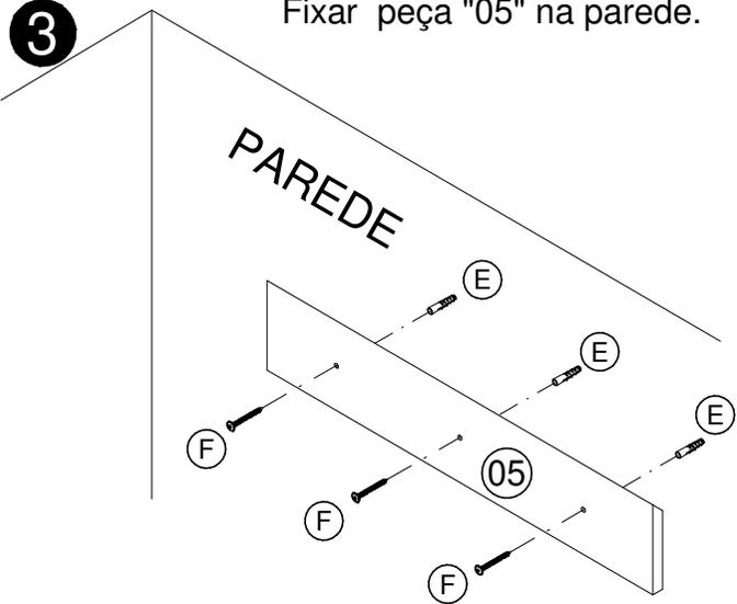
Atenção: Utilizar nível para fixação..
