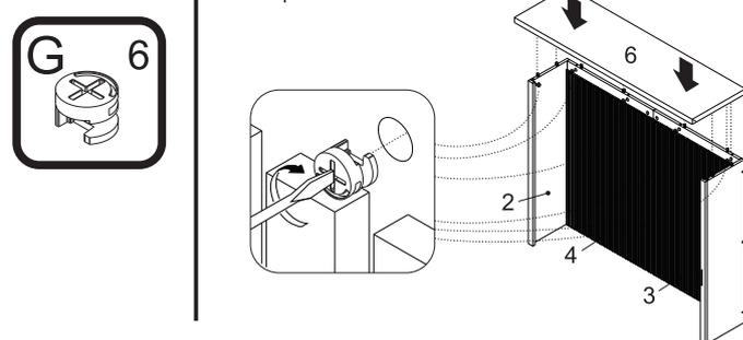
**PASSO 4** 1 - Fixar a lateral esquerda 2 no fechamento lateral esquerdo 4 com os parafusos A (7x40mm), utilizando a chave zeta F
