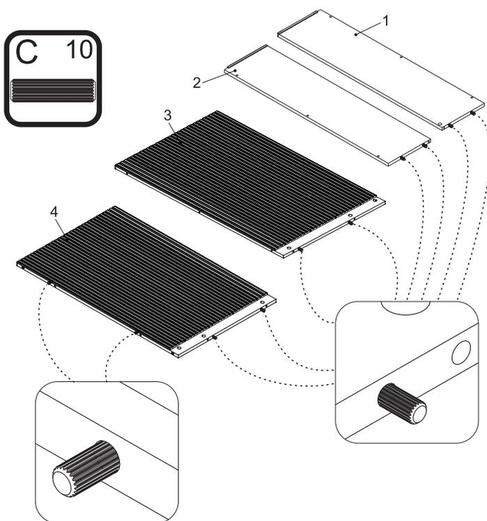
**PASSO 5** 1 - Inserir as hastes de minifix N no furo inferior e superior da peça 3 e em seguida inserir os tambores G no furo da face traseira e frontal da peça 3. Utilizar uma chave de fenda para girar o tambor até travar na haste
