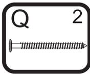
1 - Retornar com a ilha no local anterior, alinhar novamente com o balcão e fixar a cantoneira no piso utilizando o parafuso Q (6x70 mm)
