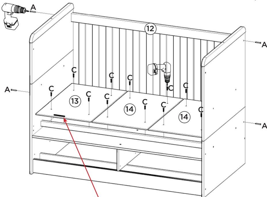
Utilizar a parafusadeira com o torque em 15 para fixar a grade e para fixar o lastre.
