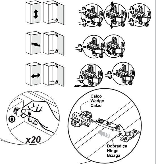
Colocar a dobradiça sobre o calço. / Place the hinge on the wedge. / Colocar la bisagra sobre el calzo.
