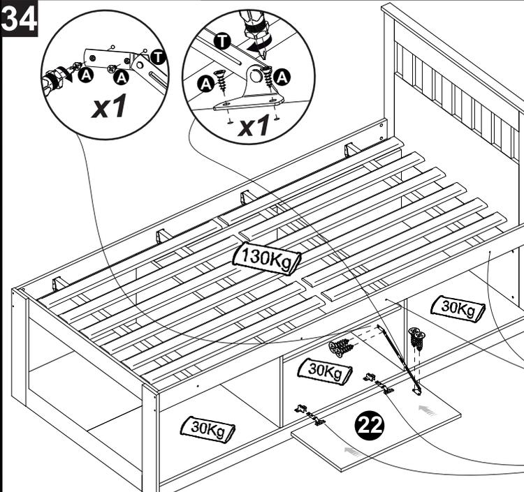
Ajuste das Portas- Ajustes de las Puertas- Doors Adjustment
