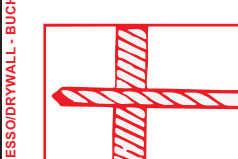
1 - Fure a parede de acordo com o diâmetro da bucha
