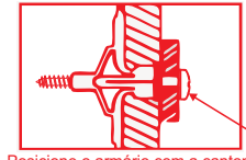
4 - Posicione o armário com a cantoneira sobre a bucha e fixe-o com um parafuso. Aperte o parafuso até a fixação estar segura
