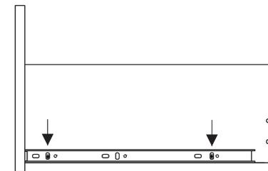
Fixação da parte móvel dos trilhos telescópicos (2011) nas gavetas (3x) com parafuso H.
