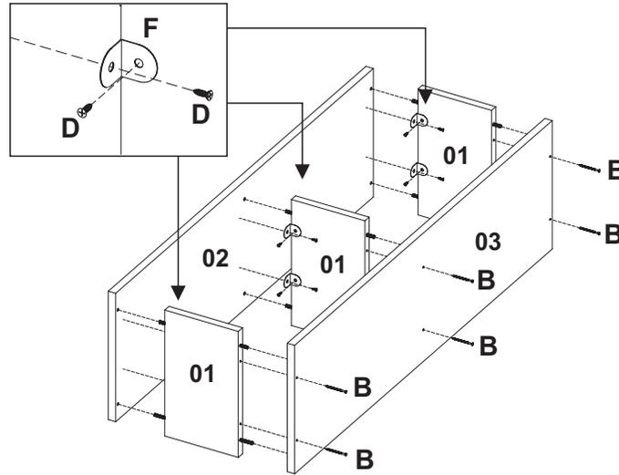
**02** - Fixar o painel inferior no móvel utilizando os parafusos **B**.
