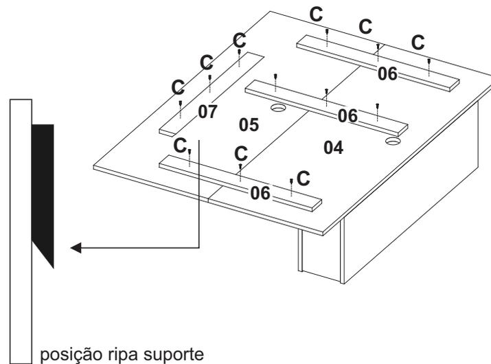
**04** - Fixar a ripa suporte na parede utilizando parafusos **A** e bucha **G**. Fixar as ripas suporte na posição (corte 45° virado para cima) conforme mostra o detalhe. Encaixar o móvel montado nas ripas suporte que foram fixadas na parede.
