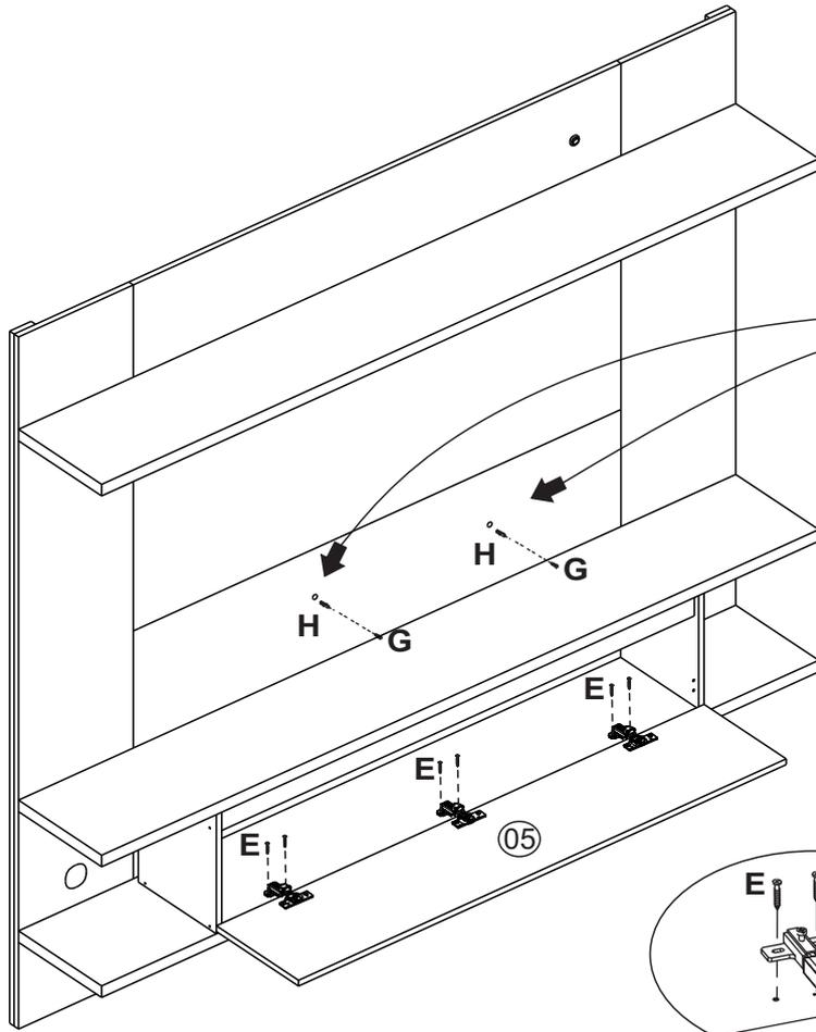
Furar o painel e a parede para fixação do parafuso auxiliar de segurança.
